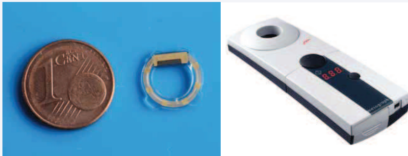
Abb. 1 a/b: a: Der faltbare intraokulare Drucksensor Argos-IO (hier im Größenvergleich mit einer Ein-Cent-Münze) enthält eine Goldspule und den Drucksensor und ist mit Silikon ummantelt. Er ist für die Implantation in den Sulcus vorgesehen. b: Mit dem Messgerät „Mesograph“ kann durch die Patienten selbst der IOD gemessen werden. Dafür wird das Messgerät so vor das Auge gehalten, dass der Patient durch das Loch sieht und für zwei Sekunden den Mess-Schalter gedrückt hält. Über Induktion in der Goldspule entsteht ein Strom und der Messvorgang beginnt. Durch ein akustisches Signal wird das Ende des Messvorganges angezeigt, und der Wert kann abgelesen werden. Zusätzlich werden die IOD-Werte im Gerät gespeichert und können in eine gesicherte Datenbank übermittelt und telemedizinisch ausgewertet werden.
